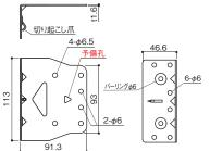
規定の金物取付け高さで丸孔にビスが 打てない場合、予備孔にビスを打ちます。
