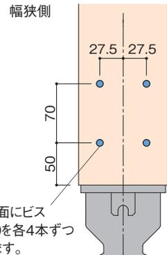
幅狭側両面にビスHQR-140を各4本ずつ打ち込みます。
