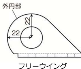
を通す穴の芯から外円部までを22mmとすることで斜め梁で位置決めしやすく、施工性とデザイン性を兼ね備えています。ハウスプラス確認検査株式会社にて引張耐力を確認しており、安心してご使用いただける製品です。
