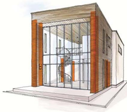
ベースセッターは、大きな開口やゆとりあるスペースの確保ができたり、天井懐の低い跳ねだしバルコニーにより斜線制限が回避できたりするなど、ベースセッターの使い方ひとつでプランニングの幅が格段に向上します。構造の検証は、通常の許容応力度計算ソフトを用いた構造計算と、当社ホームページからダウンロードいただける無料の検定ツールのみですので、簡単に設計いただくことができます。
