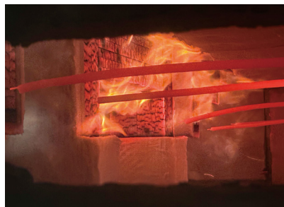
(一財) 建材試験センターにて載荷加熱試験を実施し 安全性を確認
