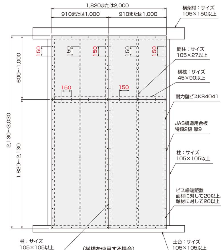
※ 横桱を柱、間柱に突きつけとし JIS A 5508 に定める N75 もしくは CN75 を 2 本斜めくぎ打ち、または同等以上の方法とする。
