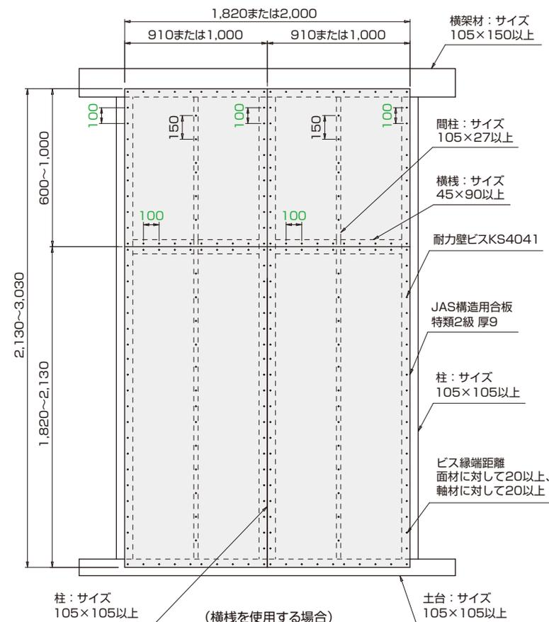
※横棧を柱、間柱に突きつけとし JIS A 5508 に定める N75 もしくは CN75 を 2 本斜めくぎ打ち、または同等以上の方法とする。
