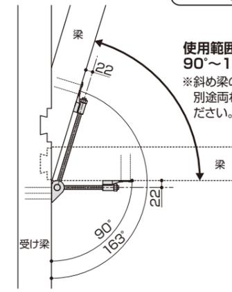
全ねじボルトは、側面・上面とも斜め梁と平行になるように取付けてください!
