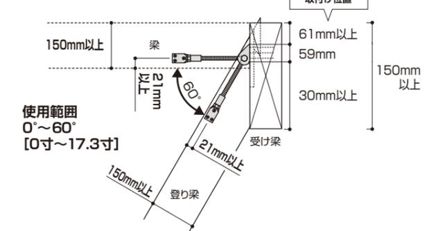
全ねじボルトは、側面・上面とも登り梁と平行になるように取付けてください!
