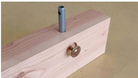
※ 直行方向に梁受金物が来る場合は、ドリフトピンの代わりに M12 中ボルトと丸座金又は PS 座付ボルトを挿入します。
