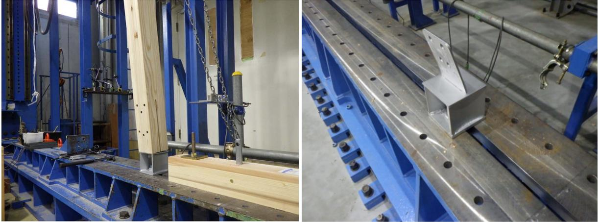
ドリフトピンを打たずに柱を傾けて、金物が変形してしまっている
