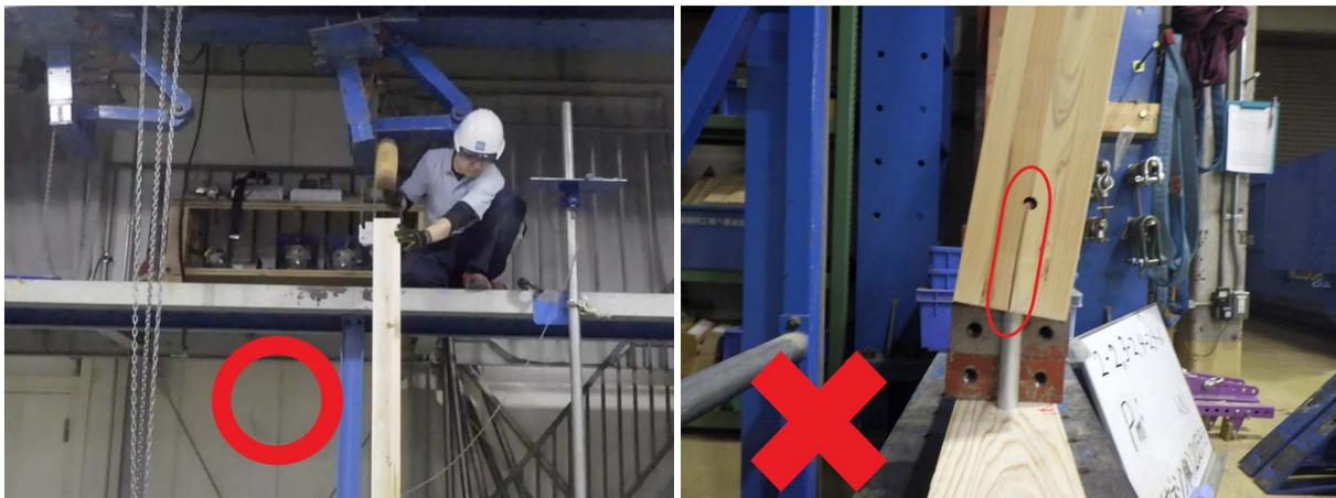
柱を揺らした結果、赤丸で囲った部分に割れが生じています。
