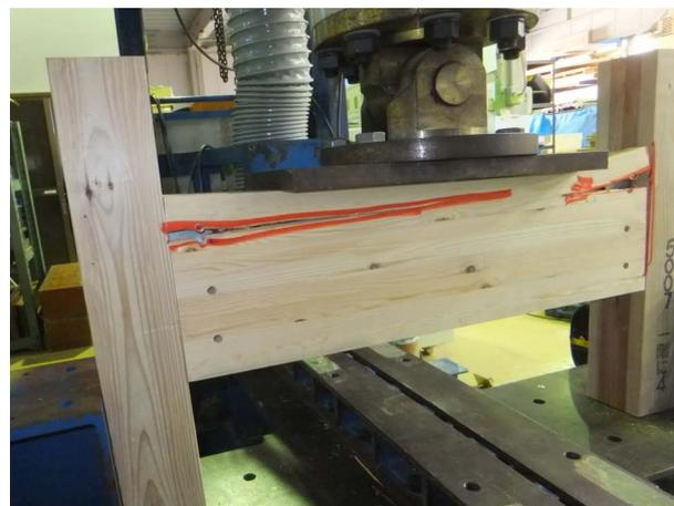
先行ピンのみで加力すると、通常の施工よりも早い段階で破壊してしまいます。(右写真)
