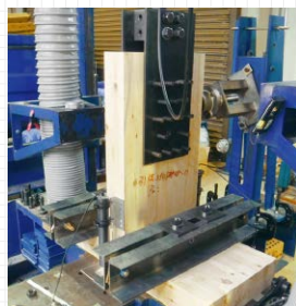
500kN鉛直アクチュエータ試験機による引張試験
