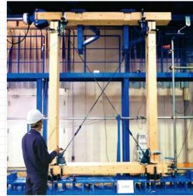
200kN面内アクチュエータ試験機による水平横面試験
