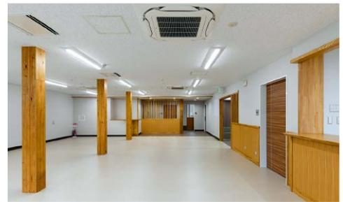
扁平柱には燃えしろ設計を適用しています。現し仕上げの多用で木の温かみを感じられる空間に仕上がっています。
