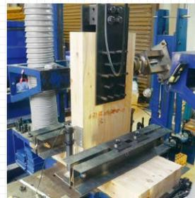
500kN鉛直アクチュエータ試験機による引張試験
