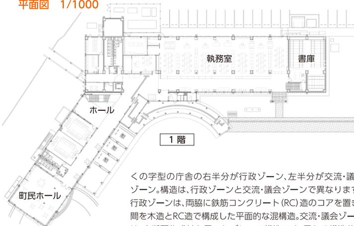
くの字型の庁舎の右半分が行政ゾーン、左半分が交流・議会ゾーン。構造は、行政ゾーンと交流・議会ゾーンで異なります。行政ゾーンは、両脇に鉄筋コンクリート (RC) 造のコアを置き、間を木造とRC造で構成した平面的な混構造。交流・議会ゾーンは、大断面集成材を用いたプレース構造です。異なる構造体の間はエキスパンションジョイントで切り分けています。
